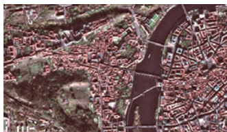
SPOT : rozlišení 10 m multispektrální, 2,5 m panchromatické.
