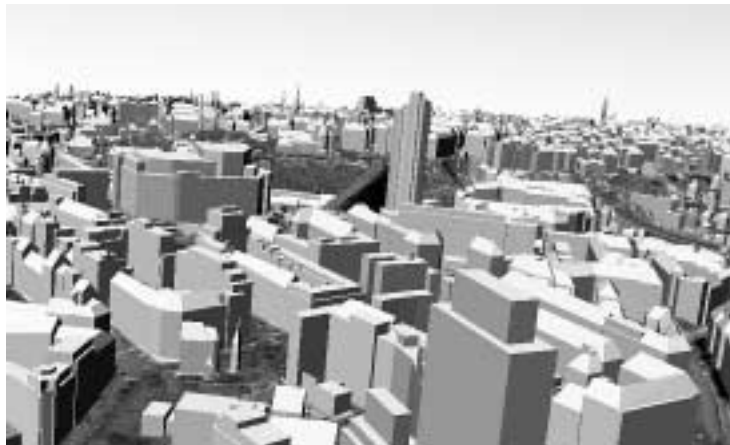
Obr.1: 3D pohled na Kongresové centrum od jihu. Model budov vytvořený v modulu Stereo Analyst je možné v prostředí VirtualGIS použít jako jednu z vektorových vrstev. Záběr je částí videosekvence.
