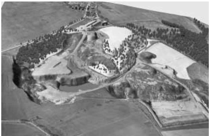
3D pohled na oblast povrchového lomu se stávající nebo navrhovanou rekultivací (formou zalesnění a zatravnění), doplněno o vyhodnocené 3D objekty budov a zařízení.
