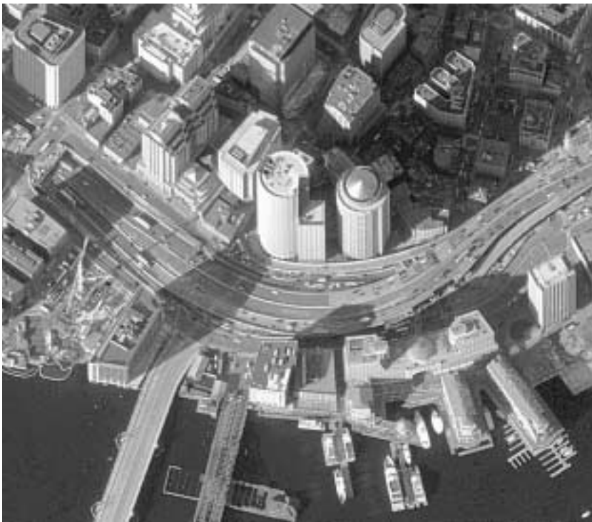
Panchromatický snímek centra Bostonu s velikostí pixelu 61 cm pořízený družicí QuickBird.
